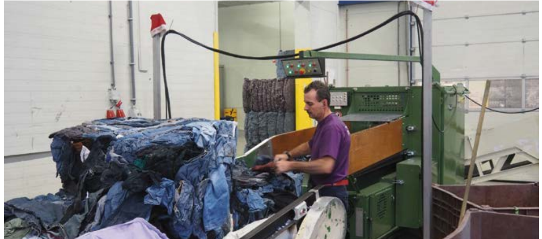
▲ Oude jeans gaan in Haaksbergen de vervezelmachine in om te worden ontrafeld.
