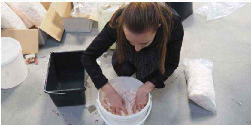
▲ Stagiaire Denise Havecate maakt de textielvezels, door water toe te voegen, gereed voor applicatie.
